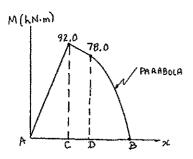
$|M|_{\text{max}} = 92.0 \text{ kN} \cdot \text{m}$
